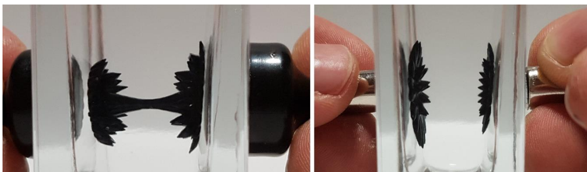
Slika 14 Privlačenje magneta (lijevo), odbijanje magneta (desno)
