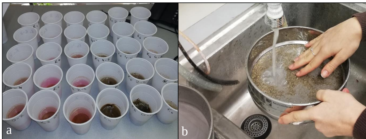
Slika 7 (a) Pod-uzorci pomiješani s Rose Bengal otopinom i (b) prosijavanje kroz sito promjera rupica 0,063 mm (foto: M. Čančar)
