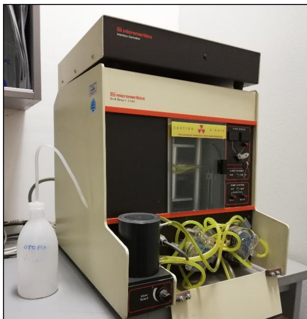
Slika 9 Sedigraf korišten pri granulometrijskoj analizi sedimenta
