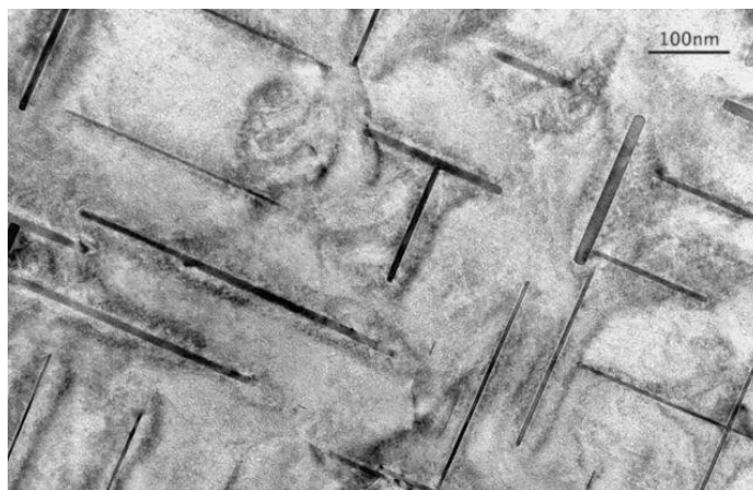
Slika 6. Legura aluminija s 4% bakra, a mikrostruktura pokazuje taloženje bakra (tamni dijelovi) unutar osnove aluminija.
