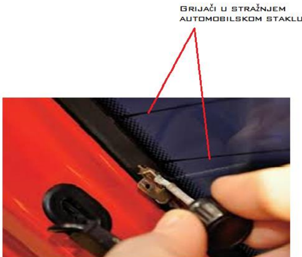
Slika 3.9. Grijači u staklu napravljeni putem sitotiska
