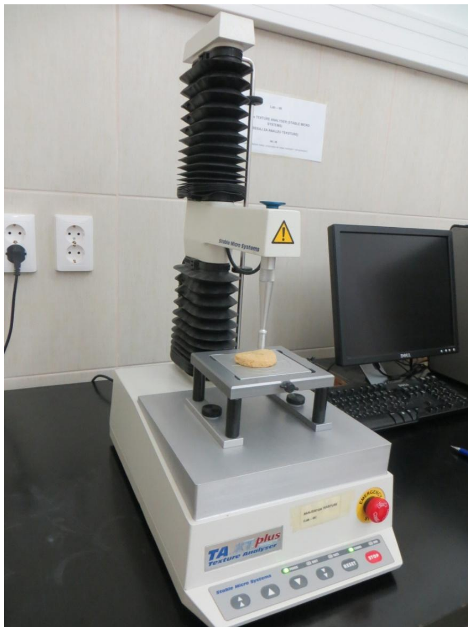
Slika 3. Analizator teksture TA.XT Plus s opremom za prodiranje u uzorak
