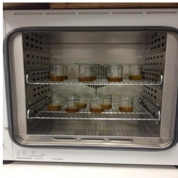
**Slika 17** Termostat sa uzorcima ispitivanih ulja
