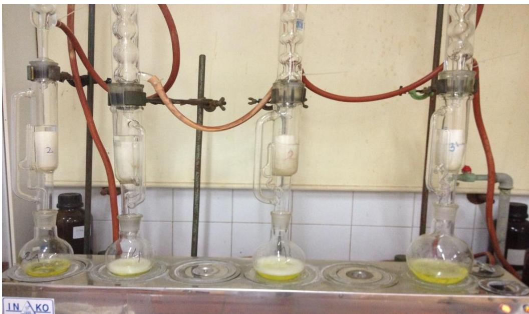
**Slika 12** Soxhlet aparatura
