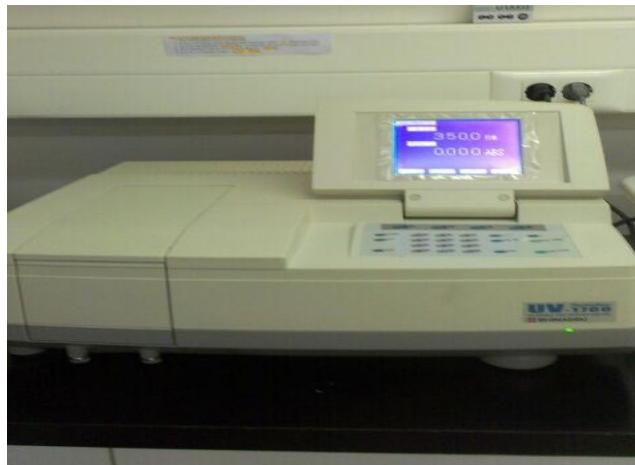
**Slika 16** Spektrofotometar
