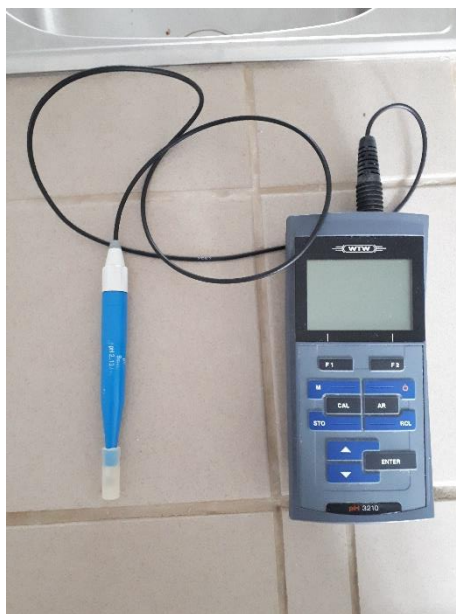
Slika 14. pHmetar WTW™ ProfiLine™ pH 3210
