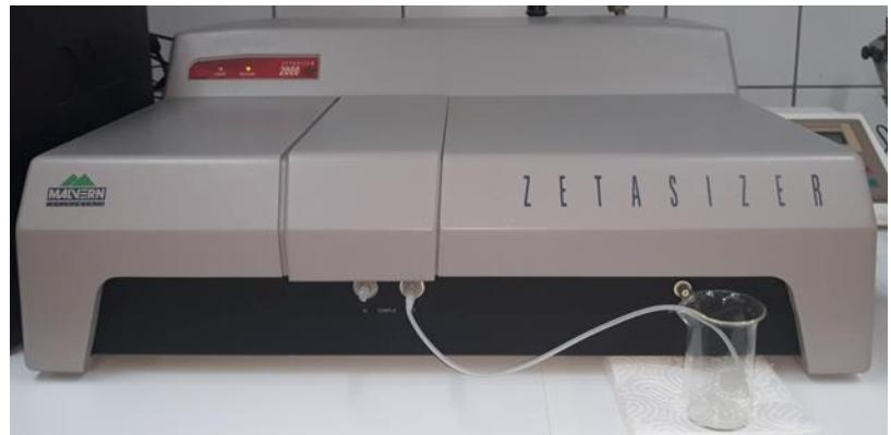
**Slika 9** Instrument za mjerjenje zeta potencijala Malvern Zetasizer 2000
