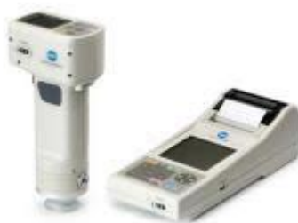
Slika 14 Kromametar Konica Micolta CR-400 (Barišić, 2018)
