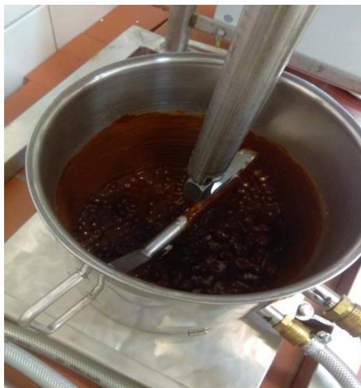
Slika 11 Prikaz unutrašnjosti kugličnog mlina
