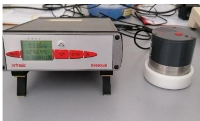
Slika 22 Uređaj za mjerenje aktiviteta vode (HygroLab 3, Rotronic)
