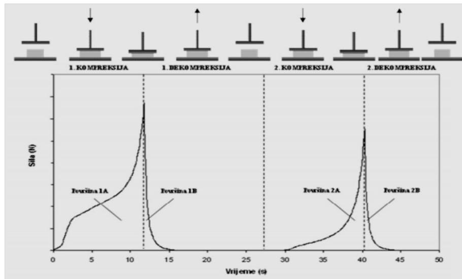
**Slika 13** Krivulja ispitivanja teksturalnog profila metodom dvostrukе kompresije
