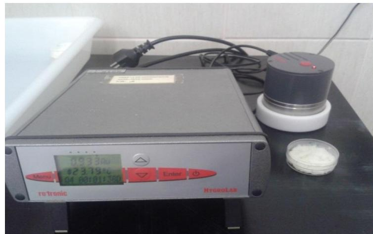
**Slika 11** HygroLab 3 (uređaj za određivanje aktiviteta vode)
