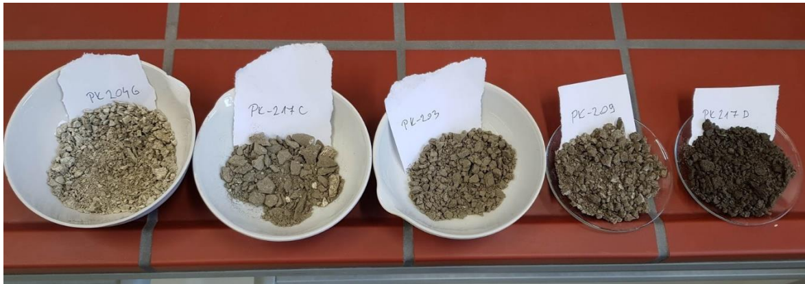
Slika 4-2. Razlika u boji ručno usitnjenih i osušenih uzoraka lapora.
