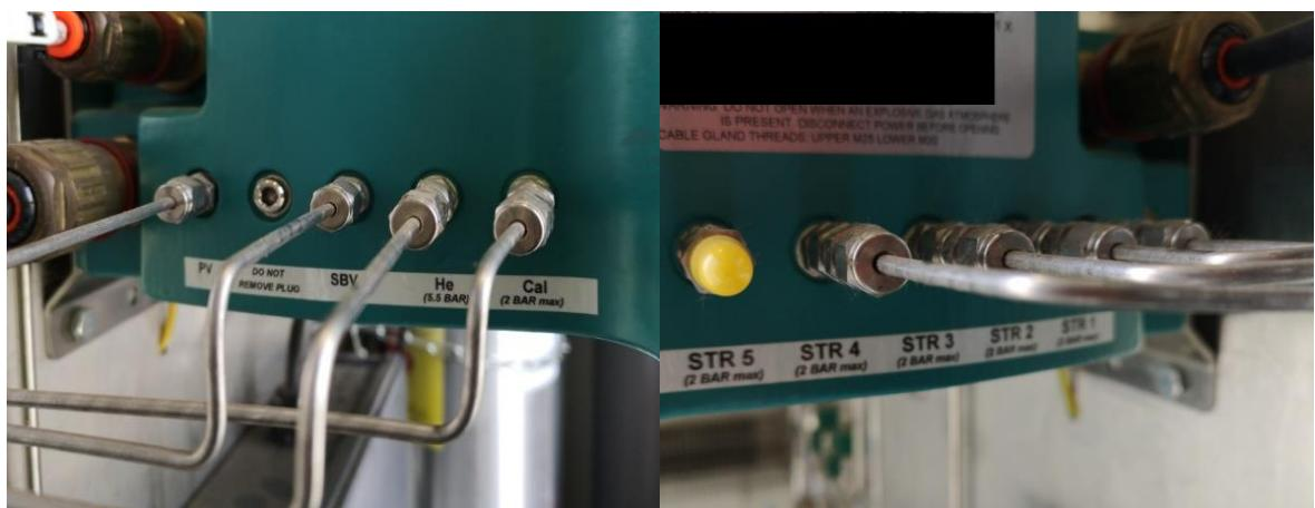
Slika 5-6. Injektori plina nosioca, kalibracijskog te uzorkovanog plina
