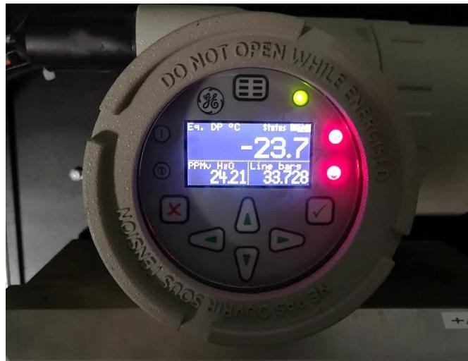
**Slika 5-10.** AURORA, analizator za mjerjenje rosišta vode u plinu
