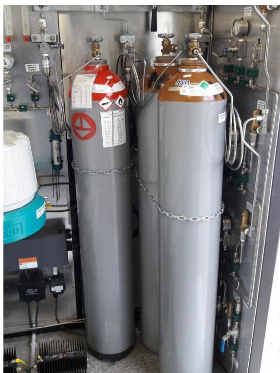
**Slika 5-7.** Boca s kalibracijskim plinom i boce s plinom nosiocem
