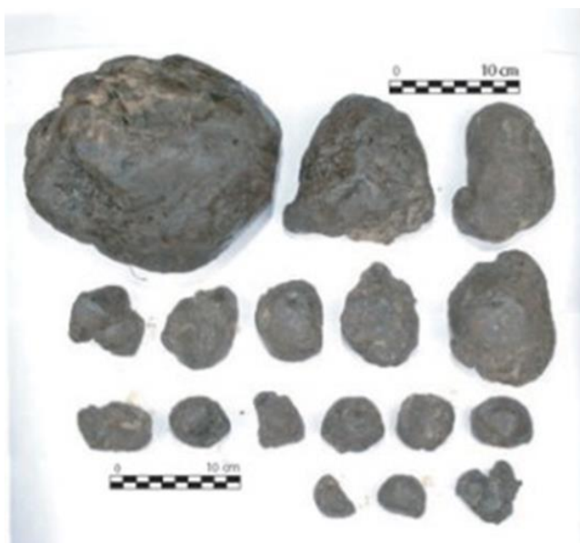
Slika 2-8. Razni tipovi katranskih lopti (McDonough 2005)
