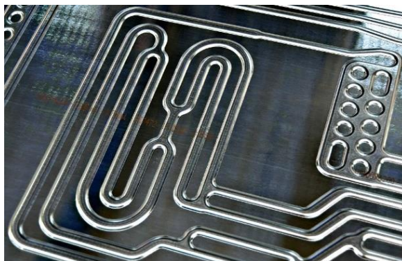
Slika 5-7. Alumijski pločasti toplinski prijenosnik (Talum (g), 2019)
