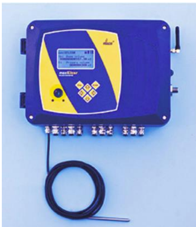
Slika 2-1. Baterijski korektor volumena plina maxiElcor (Energetika.net, 2018)
