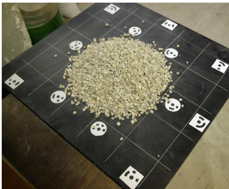
Slika 3.12 Uzorak riječnog šljunka
