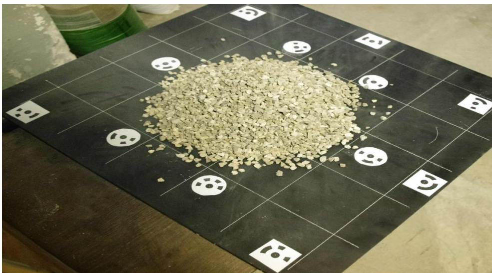
Slika 3.14 Uzorak drobljenog dolomita
