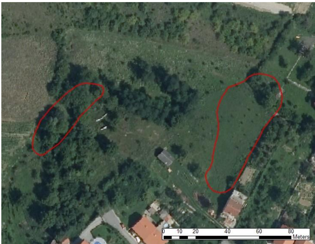
Slika 5-2 Primjer vidljivosti klizišta na DOF snimku iz 2019 godine
