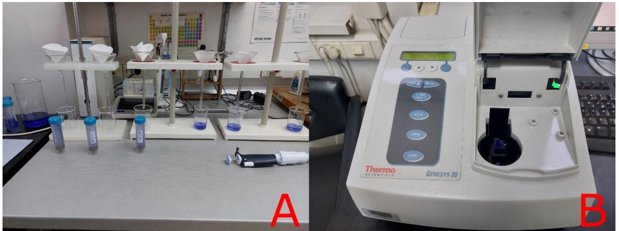
Slika 3-9. Određivanje kapaciteta kationske zamjene (CEC), A) Filtriranje uzoraka, B) snimanje uzoraka na spektrofotometru
