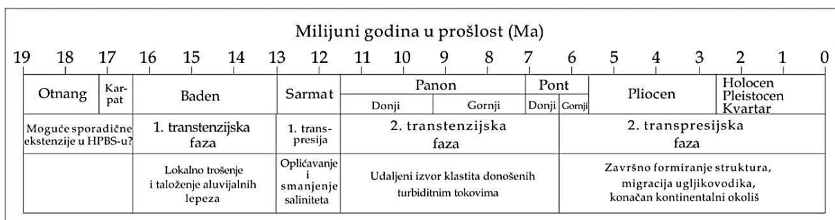
Slika 4-8. Glavni tektonski i taložni događaji u hrvatskom dijelu PBS- a (MALVIĆ i VELIĆ, 2011)
