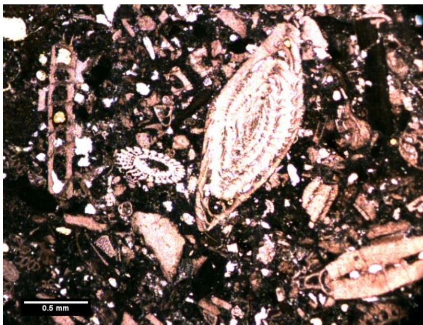
Slika 4-23. Mikrofotografija uzorka M21 - litotamnijski vapnenac
