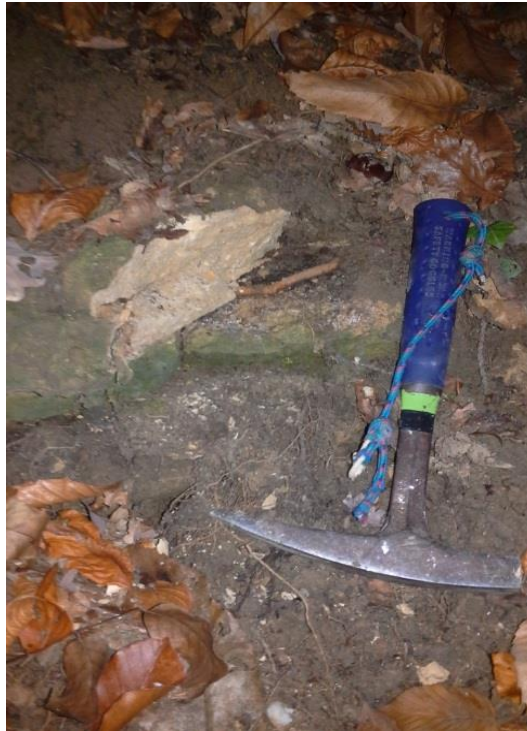
Slika 4-24. Izdanak M86 - glinoviti biokalkarenit
