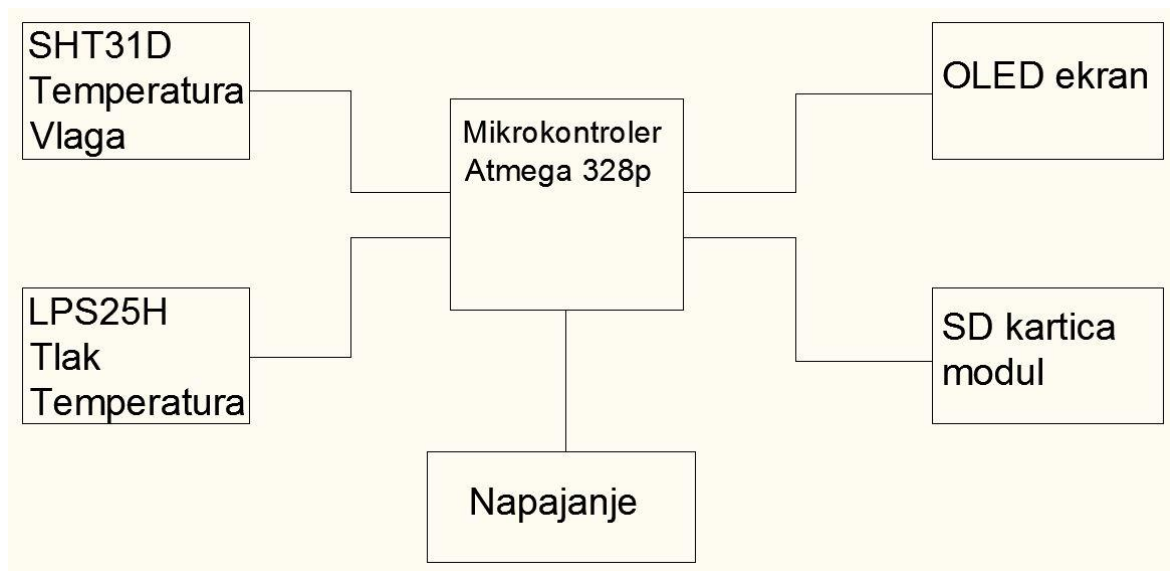
Slika 4-1 Shema Arduino instrumenta.
