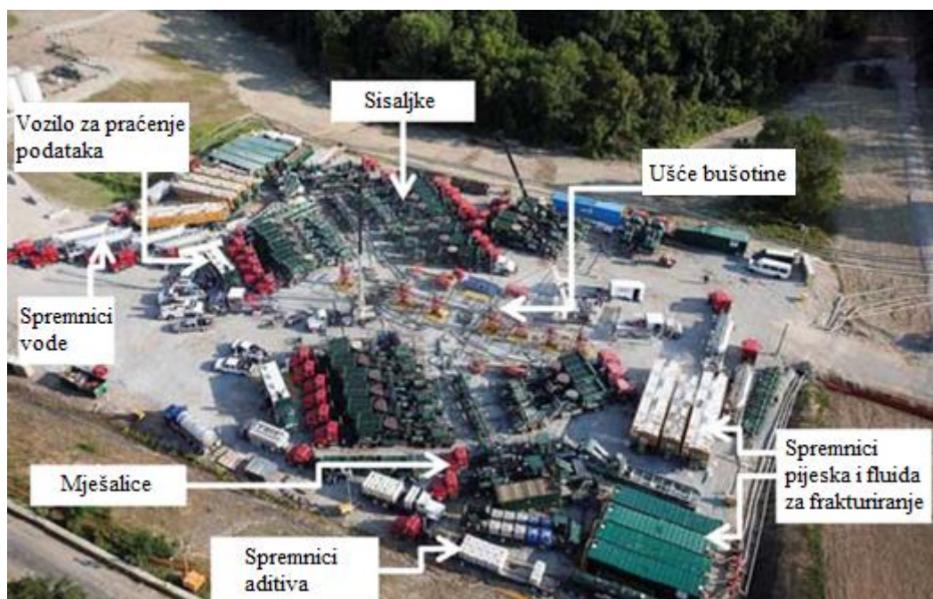
Slika 2.2. Današnji izgled opreme za hidrauličko frakturiranje, Marcellus, Pennsylvania (Suchy i Newell, 2012)
