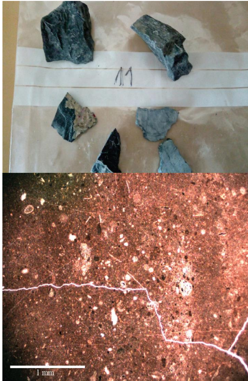
Slika 6.6. Veći broj dijelova uzorka iz sloja 11 (gore), te kalcisfere i bioturbacije u mikritu (dolje).
