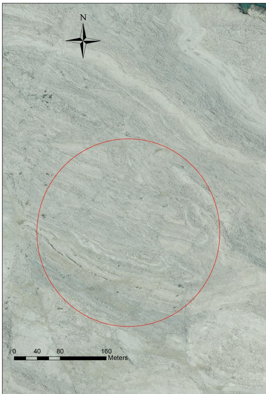
Slika 4–7. Antiklinala unutar gornjokrednih naslaga s parazitskim borama u zoni maksimalne zakrivljenosti (obilježeno crvenom kružnicom)
