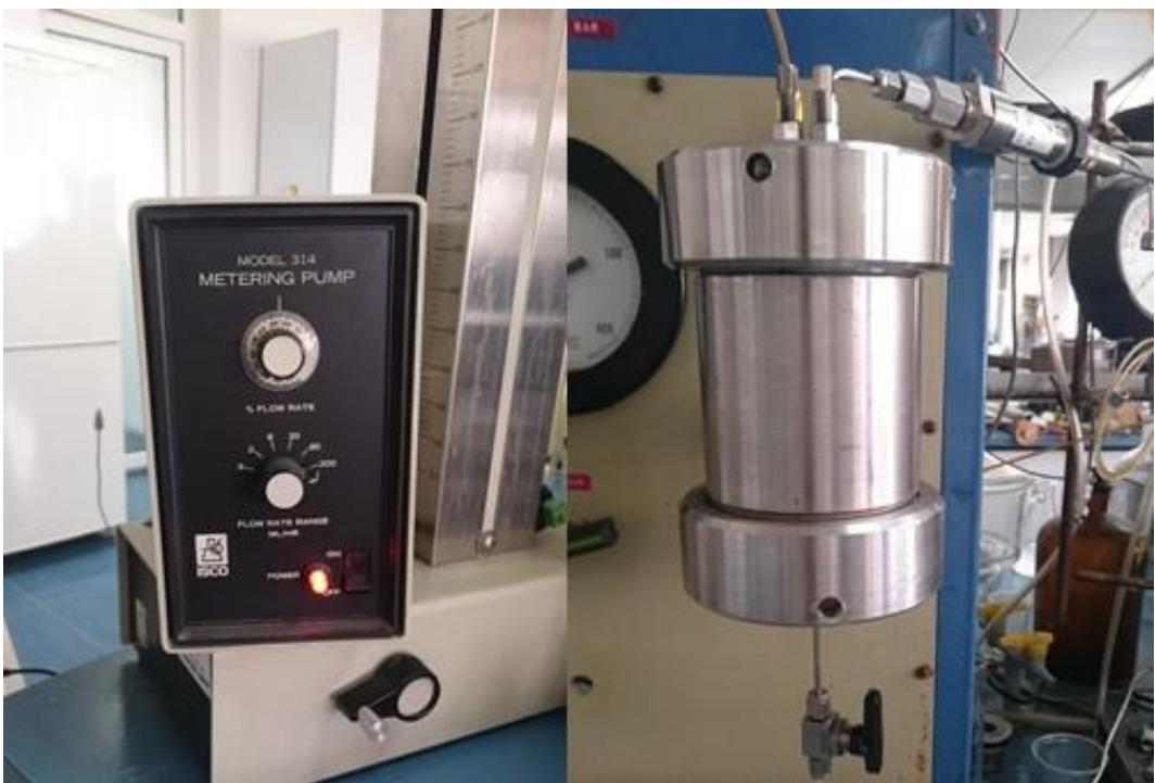
Slika 3-2. Visokotlačna pumpa i triaksijalni držač jezgre.
