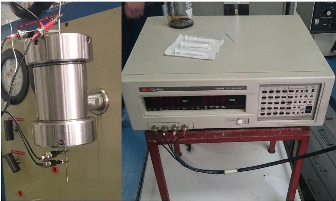
Slika 5-2. Oprema za mjerjenje otpora jezgre.
