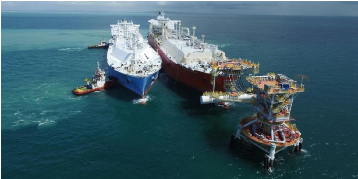
Slika 2-1. Sidrenje FSRU na bovi (www.lngworldnews.com, 2014)
