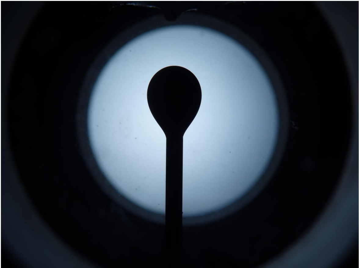
Slika 5-6. Fotografija kapljice nafte u sustavu voda - sirova nafta na tlaku od 150 bara
