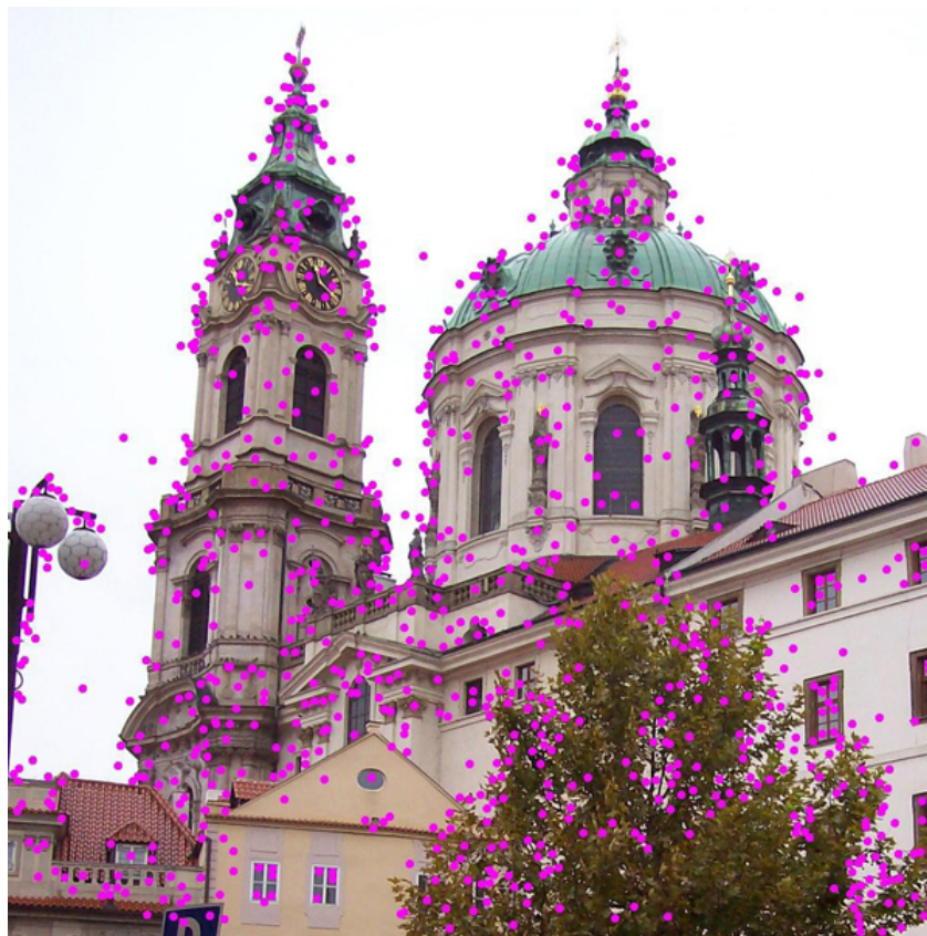
Slika 3.4 Značajne točke nakon SIFT algoritma
