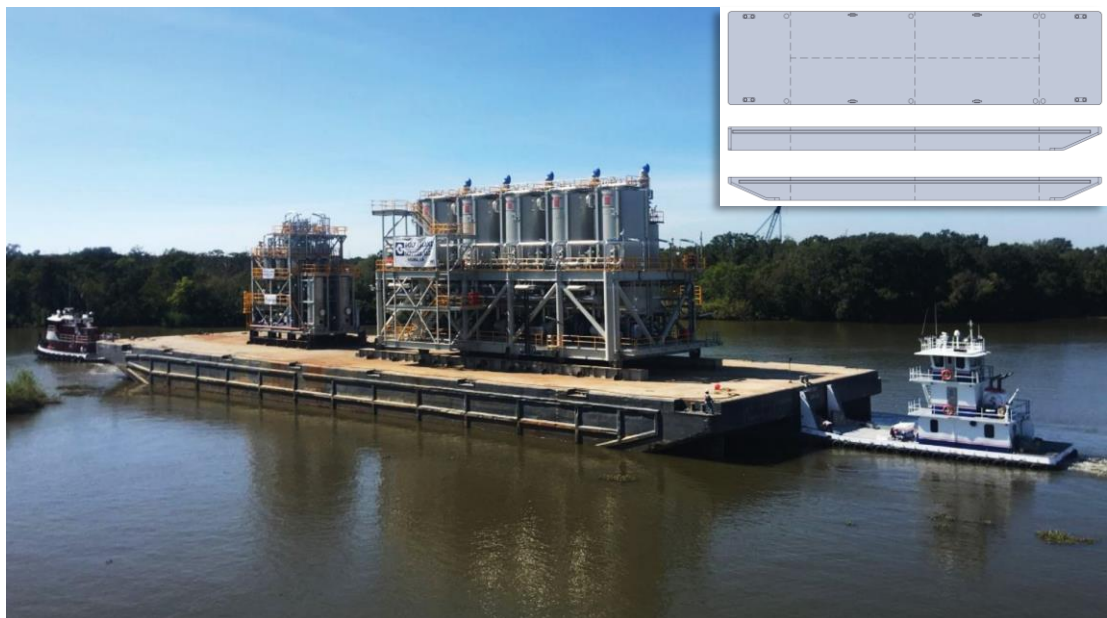
Slika 2.4. Deck barge – teretna barža [3].
