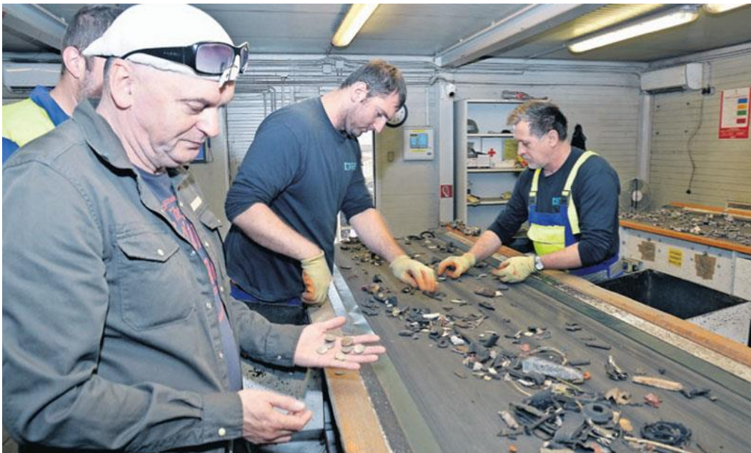
Slika 3.3. Posljednja faza odvajanja dijelova automobila za reciklažu [19]
