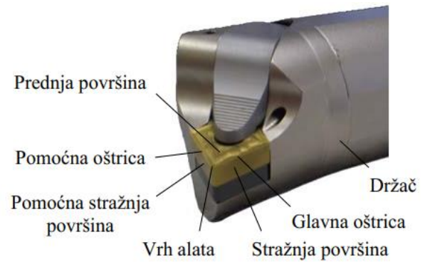
Slika 2.1.2. Rezni klin alata, površine i oštrice alata [1].
