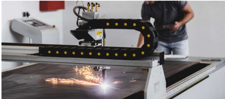
Slika 2.5 Primjer kartezijskog robota [2]
