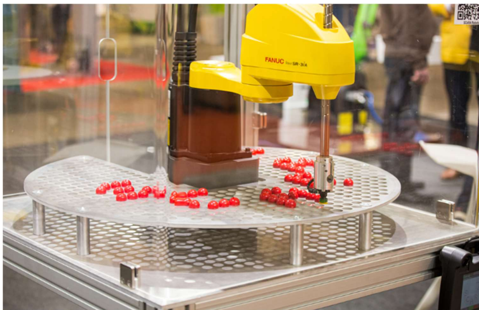
Slika 2.4 Primjer SCARA robota [2]
