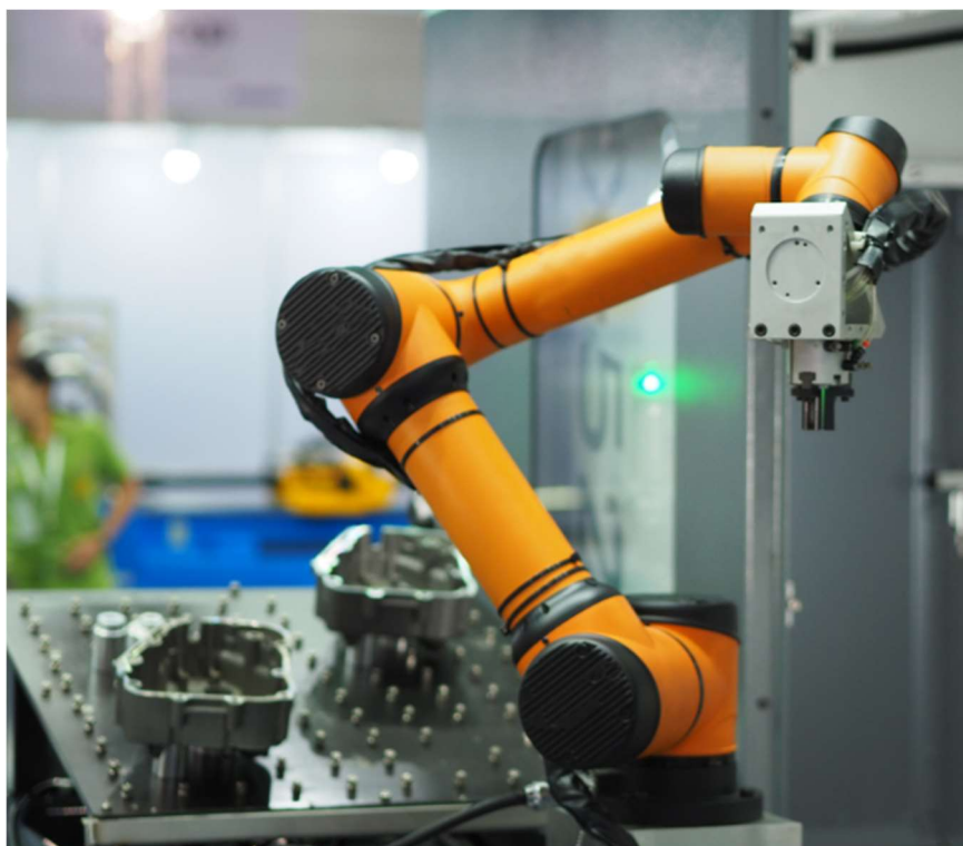
Slika 2.2 Primjer 6-osnog robota [2]
