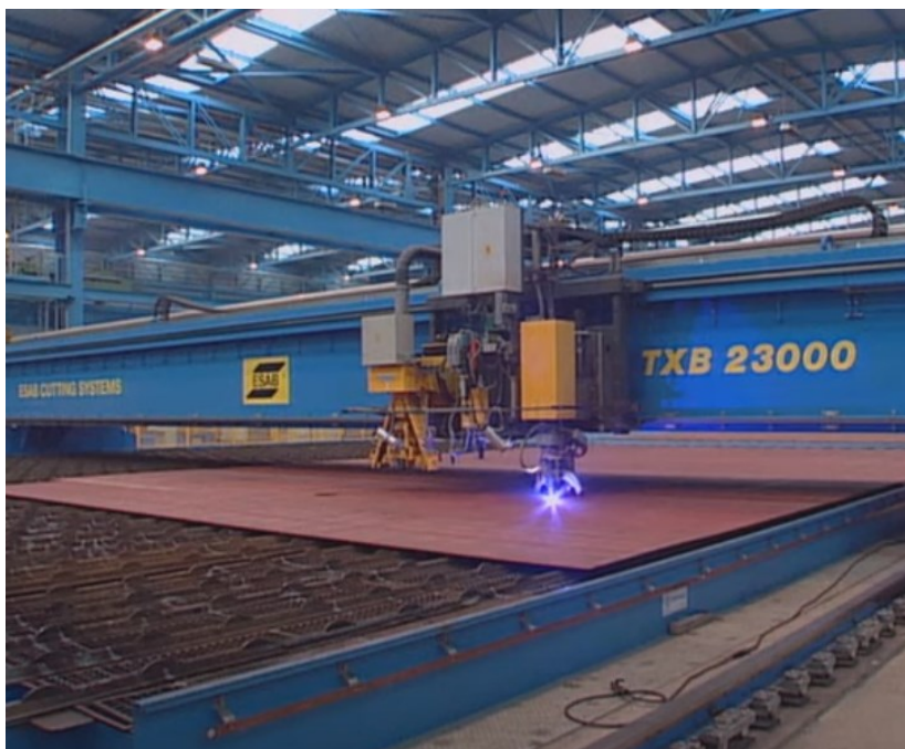
Slika 4.3.1.1. Paralelno plinsko rezanje brodskih limova
