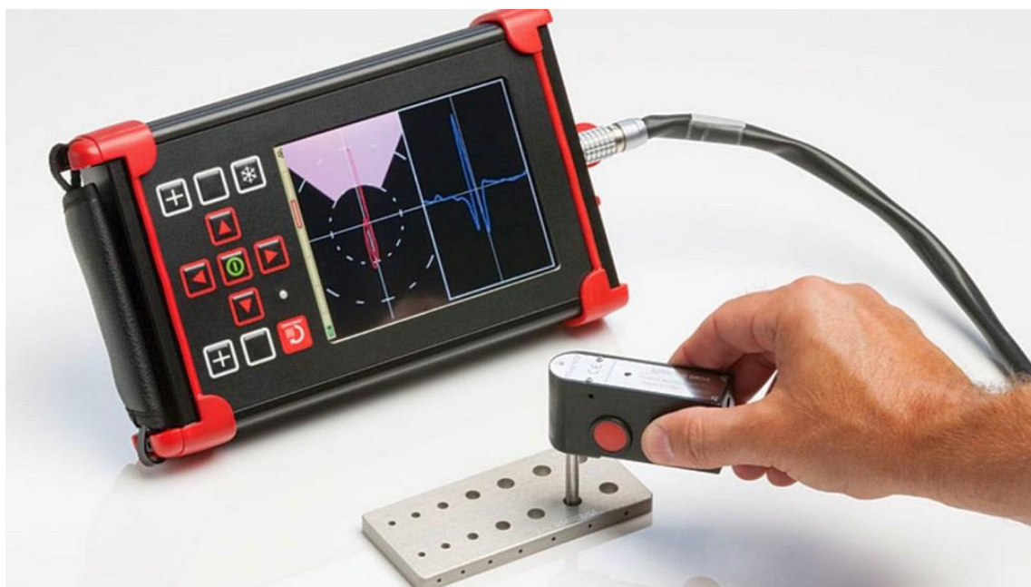
Slika 2.9. Uređaj za ispitivanje vrtložnim strujama [24]
