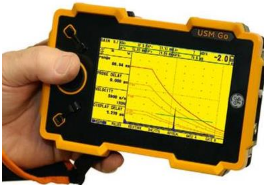
Slika 2.3. SUM Go ultrazvučni defektoskop [20]
