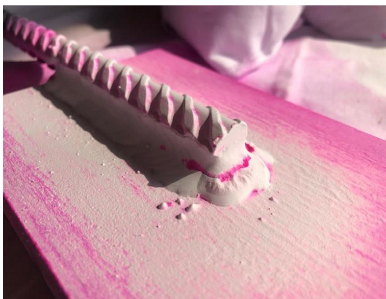
Slika 2.8. Ispitivanje zavara penetrantima [23]
