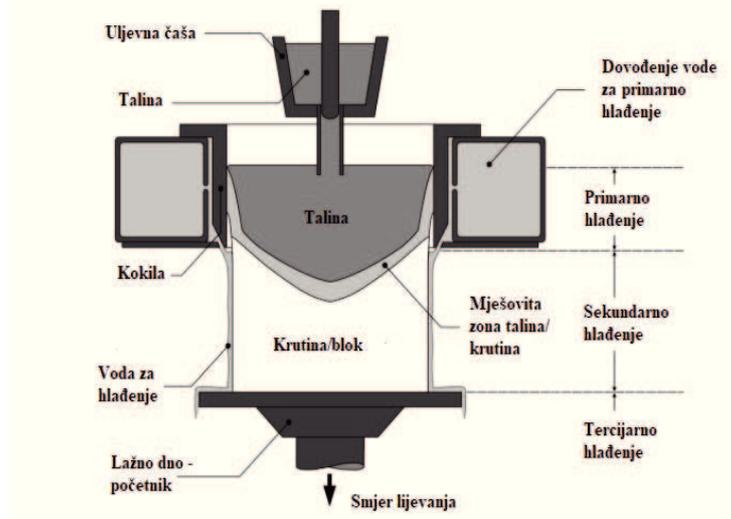
**Slika 5. Shematski prikaz VDC postupka [38]**
