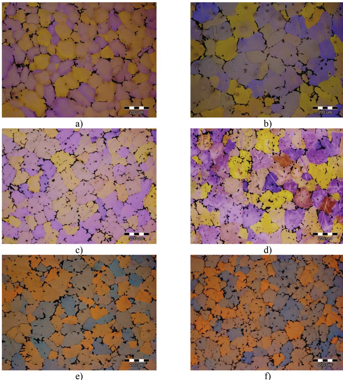
**Slika 37. Snimke mikrostrukture uzoraka šarže 3157 aluminijske legure EN AW-5083**
