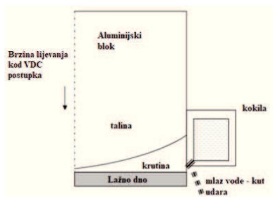
**Slika 6. Shematski prikaz usmjeravanja mlaza vode na skrtnutu koru tijekom sekundarnog hlađenja VDC postupkom [40]**
