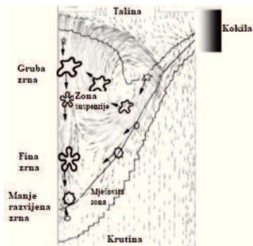
**Slika 11. Shematski prikaz tipičnog toka taline u prijelaznoj zoni meniskusa kod DC postupka lijevanja bloka s likvidus, koherentnim i solidus izotermama koje odvajaju tekuću zonu, zonu suspenzije, mješovitu zonu i krutu zonu unutar bloka [51]**
