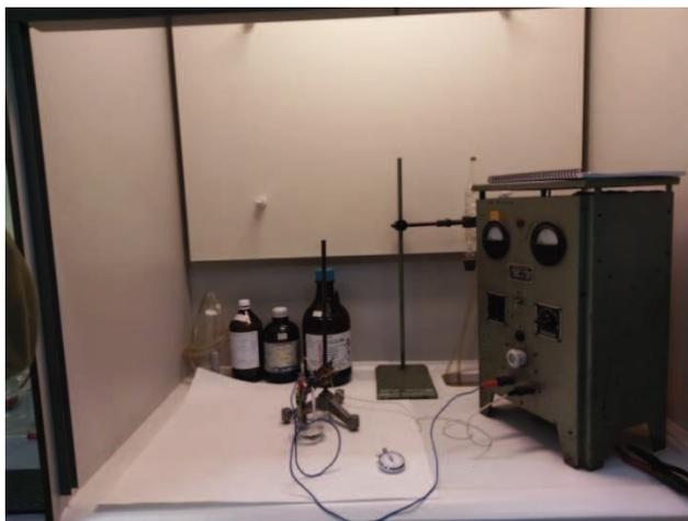
**Slika 34. Elektrolitičko nagrivanje uzoraka (aparatura)**
