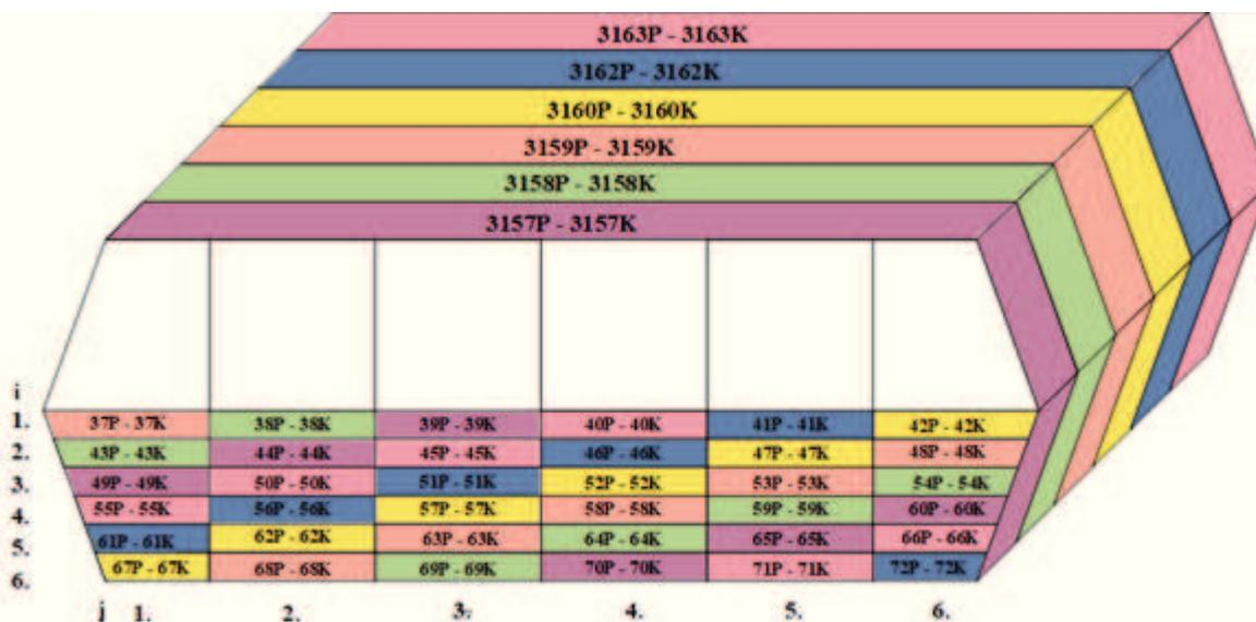
**Slika 30. Prikaz uzimanja uzoraka kroz svih 6 ispitivanih blokova**
