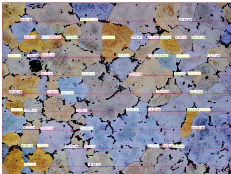
**Slika 36. Primjer određivanja veličine zrna poluautomatskom metodom mjerenja duljine presijecanja zrna na uzorku 48PA iz šarže 3159P nagriženim Barkerovim reagensom promatran pod polarizacijskim svjetlom uz dodatak tintnog filtra**
