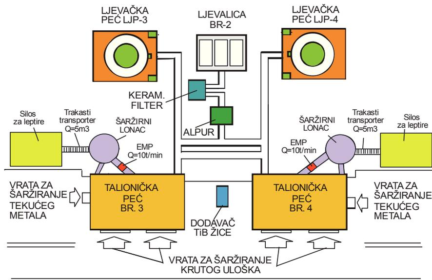
**Slika 13. Shematski prikaz postupka izrade blokova polukontinuiranim vertikalnim postupkom lijevanja, VDC postupak [8, 36]**
