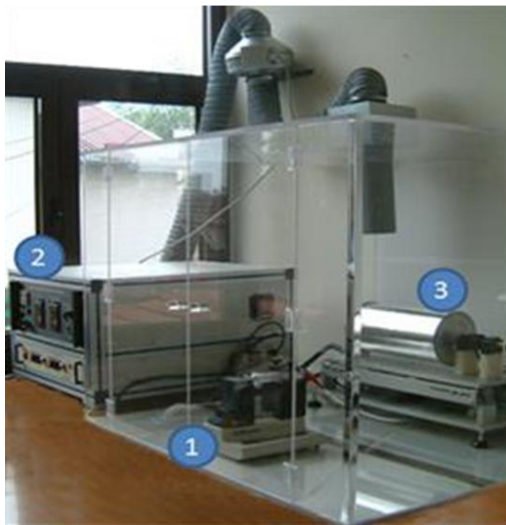
Slika 5. Uređaj za elektroispredanje: 1.- pumpa i igla 2.- izvor visokog napona, 3. - kolektor
