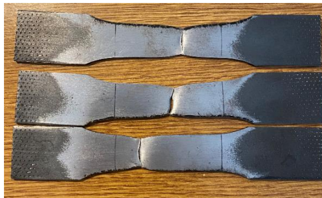
Slika 41. Uzorci nakon statičkog vlačnog ispitivanja kut 45^\circ
