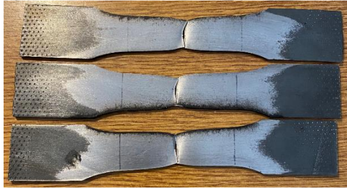
Slika 39. Uzorci nakon statičkog vlačnog ispitivanja kut 0^\circ
