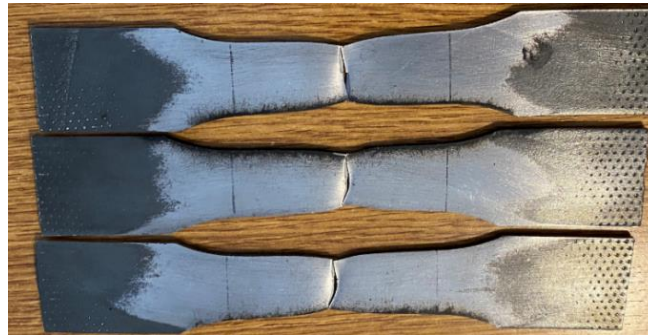
Slika 40. Uzorci nakon statičkog vlačnog ispitivanja kut 90^\circ
