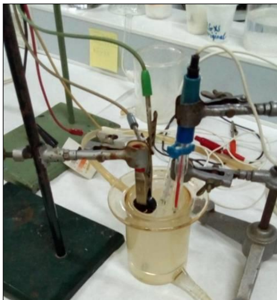
Slika 38. Troelektrodna staklena ćelija za elektrokemijska mjerenja
