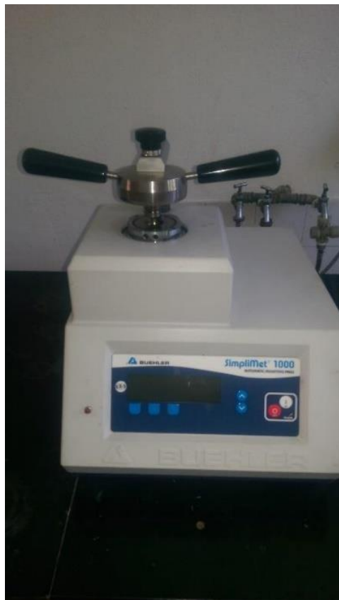
Slika 41. Uređaj za ulaganje uzoraka vrućim prešanjem SimpliMet® 1000 [38]
