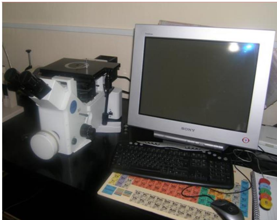
Slika 43. Optički mikroskop Olympus GX 71 s digitalnom kamerom DP70 [38]
