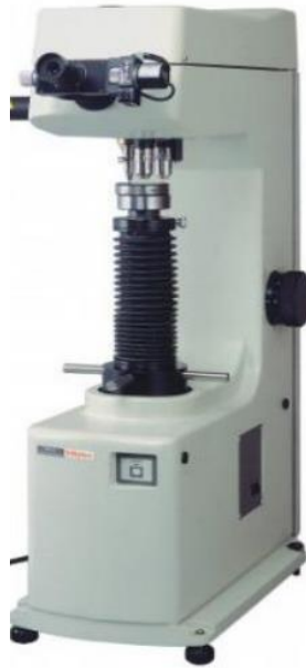
Slika 14. Fotografija uređaja za ispitivanje tvrdoće po Vickersu
