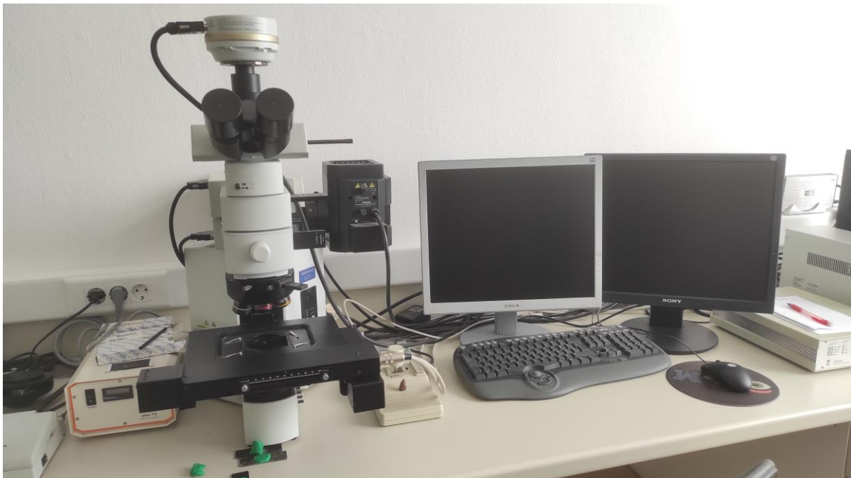
Slika 13. Fotografija optičkog mikroskopa proizvođača Olympus BX61
