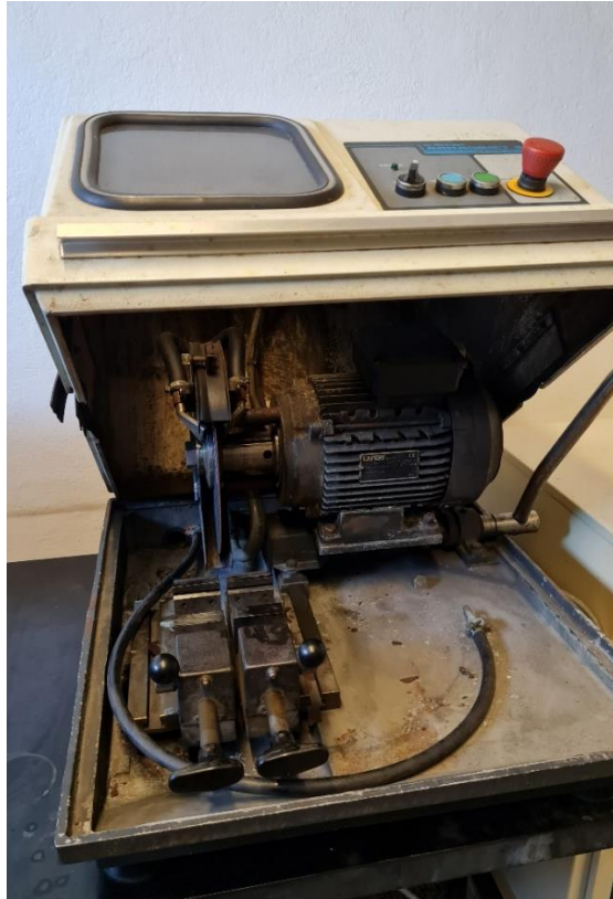
Slika 11. Fotografija uređaja za rezanje uzoraka Isomet Buehler
