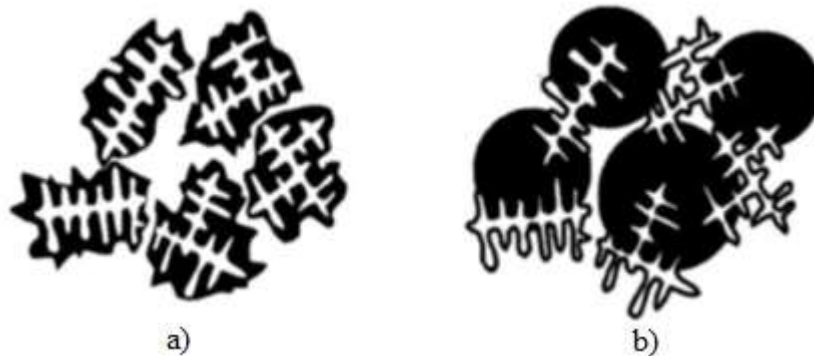
Slika 29. Shematski prikaz nastajanja eutektika prema postojećim mehanizmima
