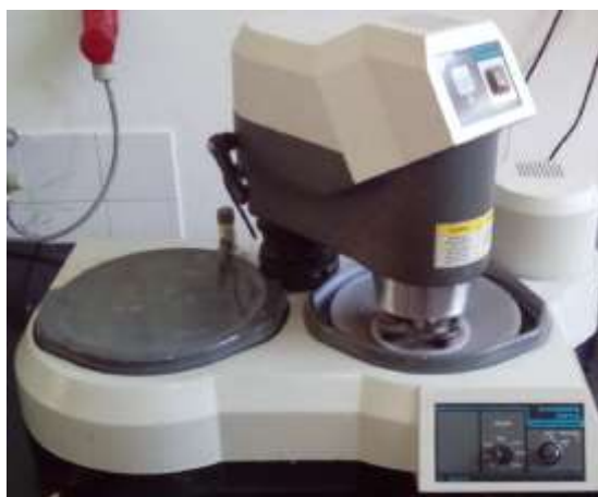
Slika 46. Uređaj za brušenje i poliranje Vector LC
