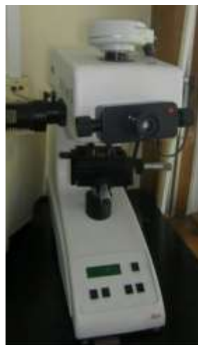
Slika 50. Mikrotvrdomjer Leica VMHR [43]
