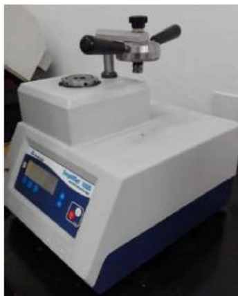
Slika 45. Uređaj za zalijevanje uzoraka SimpliMet 1000
