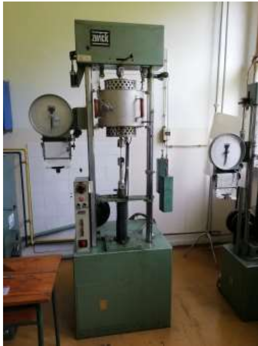
Slika 48. Kidalica proizvođača ZWICK
