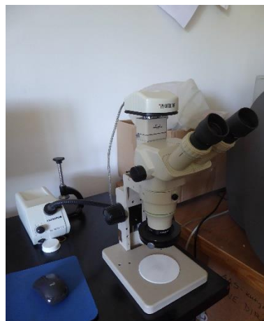
Slika 33. Stereo mikroskop Olympus Promicra SZ-CTV za fraktografsko ispitivanje
