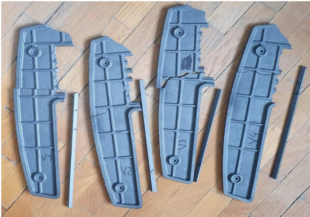
Slika 52. Gornji dio odljevka za ispitivanje i uzorkovanje
