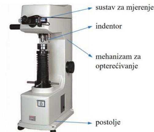
Slika 14. Tvrdomjer i njegove komponente
