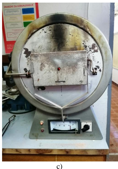
Slika 34. Označeni uzorci: a) postavljeni na podložak, b) umetnuti u elektro peć i c) zagrijavani u elektro peći
