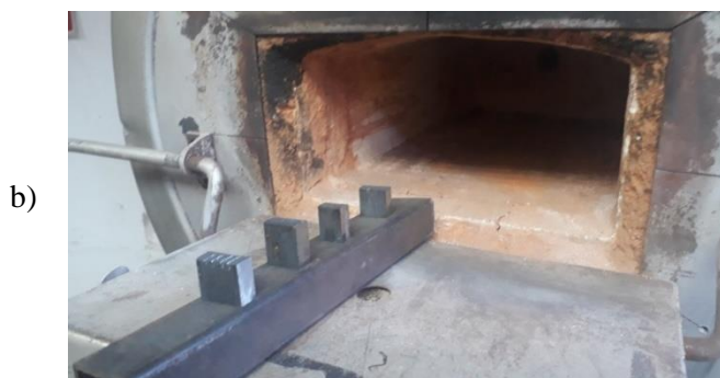
Slika 34. Označeni uzorci: a) postavljeni na podložak, b) umetnuti u elektro peć i c) zagrijavani u elektro peći
