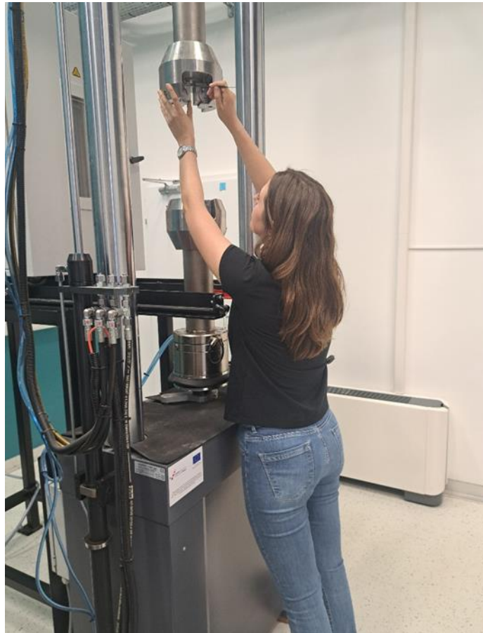
Slika 31 Radni položaj operatera pri promjeni čeljusti (slučaj 1)
