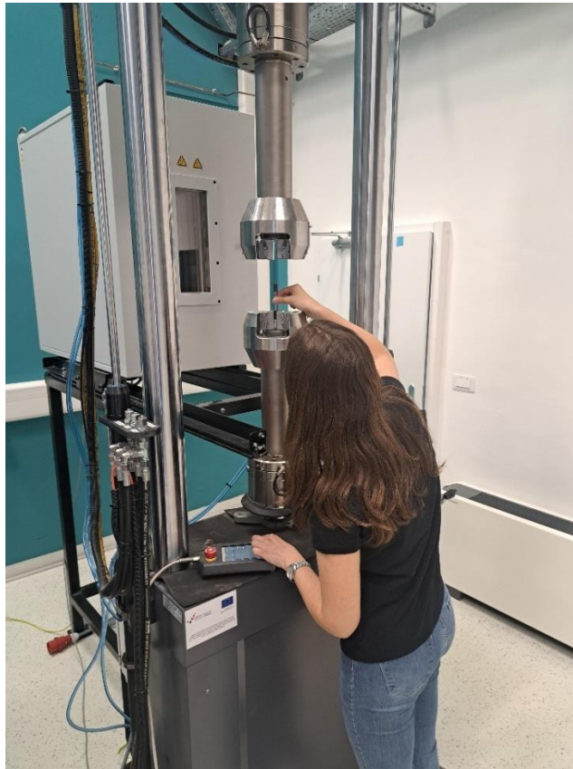
Slika 39 Radni položaj operatera pri postavljanju epruvete (slučaj 2)
