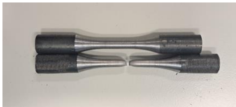
Slika 54 Epruvete prije i nakon izvedenog cikličkog testa
