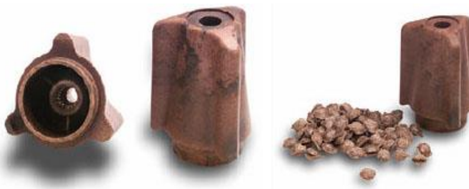
Slika 15. Granule i proizvod od materijala Arboform ®
