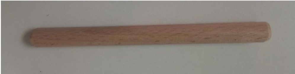
Slika 13. Bukovi moždanik korišten kod rotacijskog zavarivanja drva
