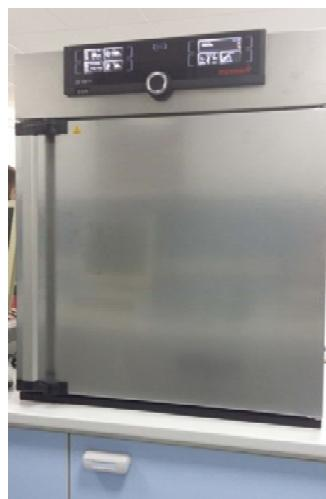
**Slika 3.** Laboratorijski sušionik Memmert UF110 plus
