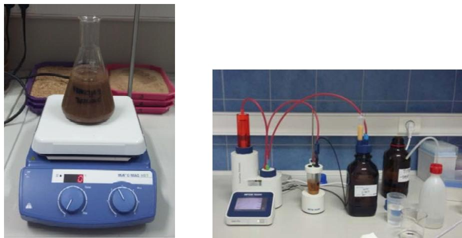
*Slika 4. Elektromagnetska mješalica i digitalni titrator*
