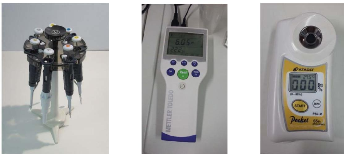
*Slika 5. Manualni pipetori pH metar i refraktometar Pal-α*
