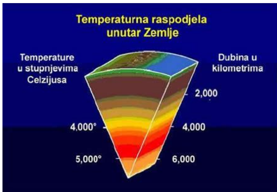
Slika 4. Presjek Zemlje s temperaturnom raspodjelom (izvor: http://www.obnovljivi.com/geotermalna-energija/67-iskoristavanje-geotermalne-energije-u-energetici?showall=1 )
