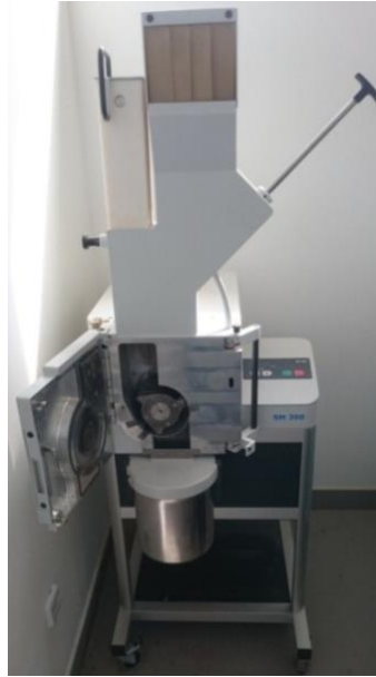
Slika 18. Mlin za usitnjavanje Retsch SM 300 sa spiralnim nožem i sitom četvrtastog otvora 4 mm
