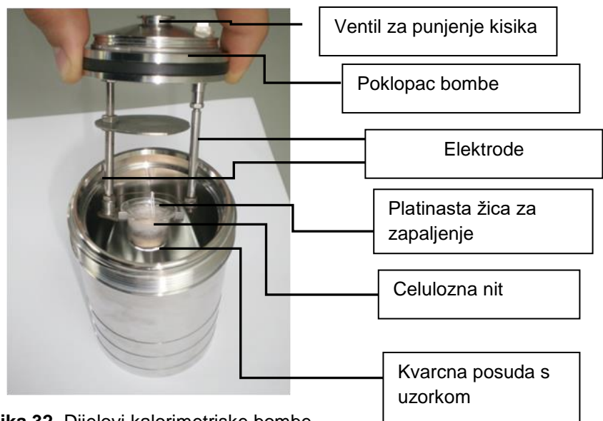
Slika 32. Dijelovi kalorimetriske bombe
